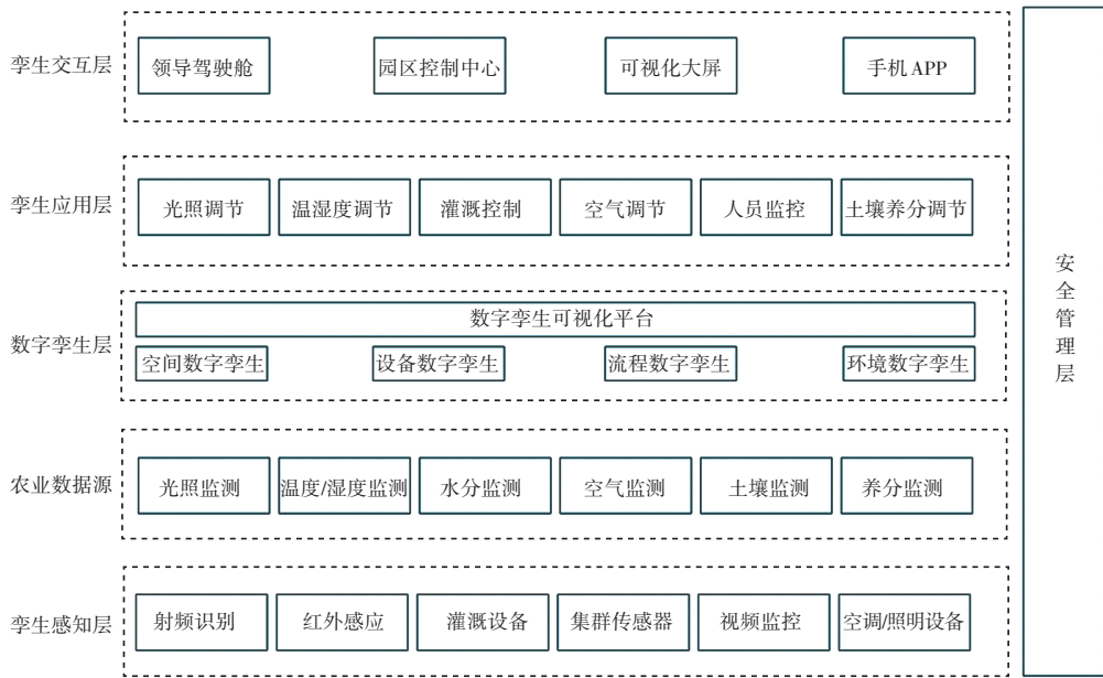
图 1 基于数字孪生的智慧农业环境监测系统架构图
