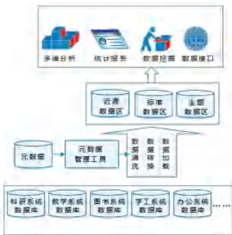
图1 高校数据仓库的架构设计
