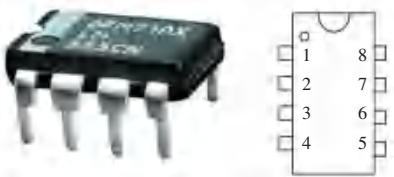
图 1 555 集成电路实物图及引脚图
